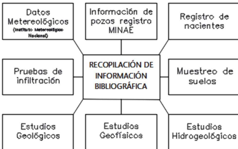
**Figura 11. Esquema de requerimientos técnicos utilizados en la elaboración de la propuesta hidrogeológica.**
